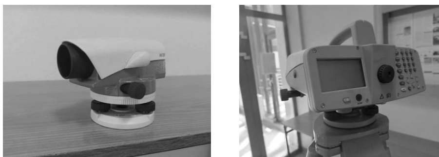
Rysunek 1. Niwelator techniczny Leica NA720 oraz niwelator precyzyjny Leica DNA03.
